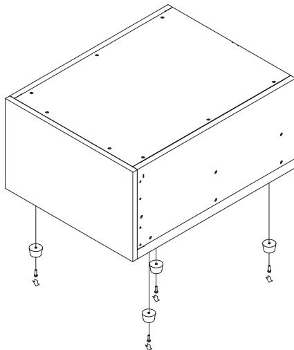
2. 付属のねじを使用してブラケットを図のように取り付けます。
